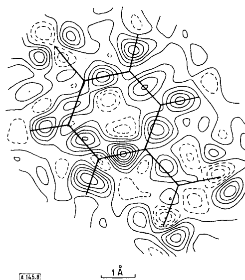
Abb. 8. Deformationsdichte in der Molekülebene von p -Nitropyridin- N -oxid bei 30 K. Die \text{NO}_2 -Gruppe ist unten rechts auf der Dichtekarte zu erkennen, der NO-Teil des Moleküls oben links. Konturintervalle bei 0.10 \text{ eÅ}^{-3} ; negative Konturen gestrichelt. Nach Wang et al. sowie Coppens und Lehmann [19].
